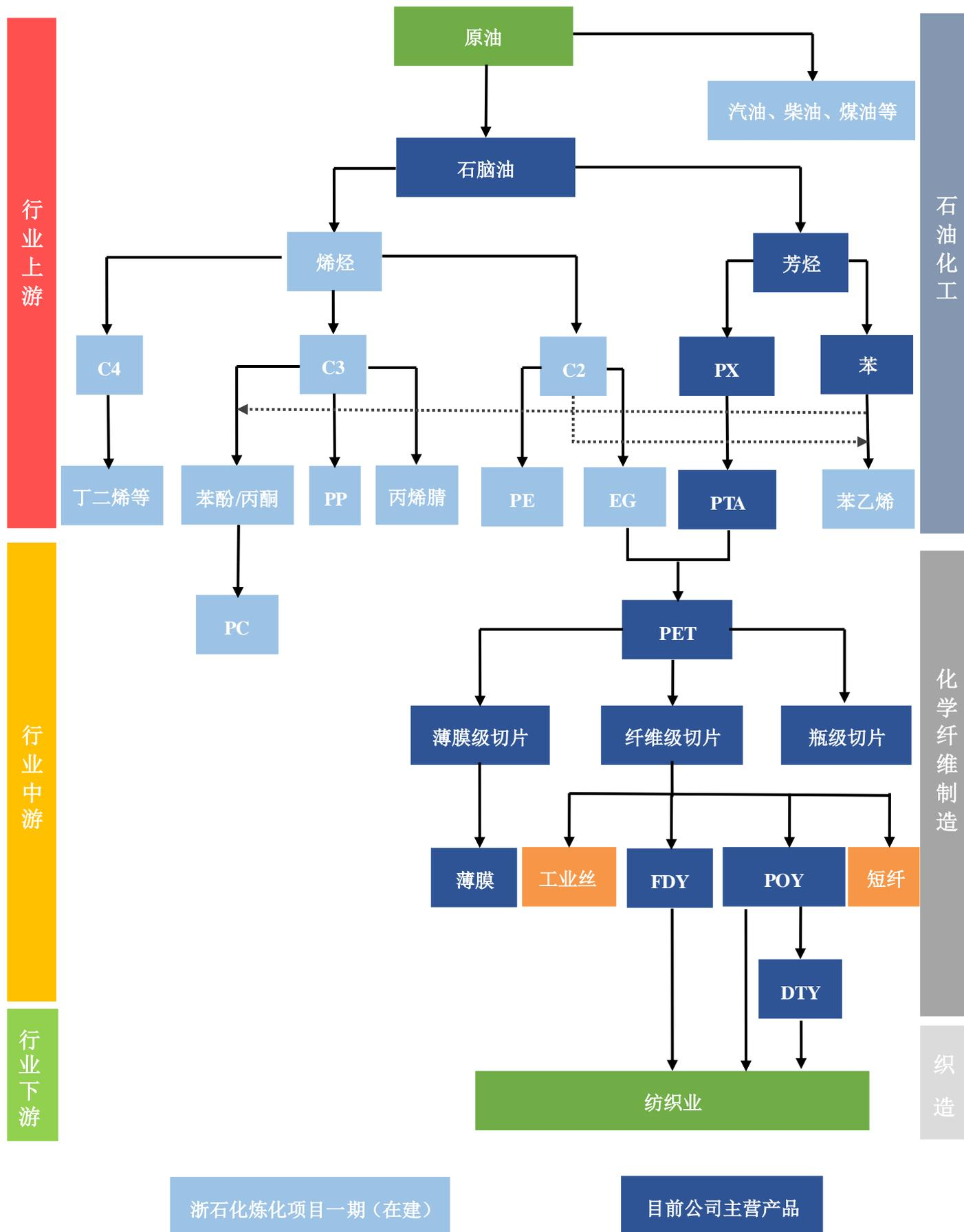
芳烃是芳香烃的简称，通常指分子中含有苯环结构的碳氢化合物。芳烃主要包括苯、甲苯、二甲苯等，是生产石油化工产品最重要的基础原料之一，主要用于制造合成树脂、合成橡胶、合成纤维、表面活性剂等，也可以用作溶剂或添加剂。
