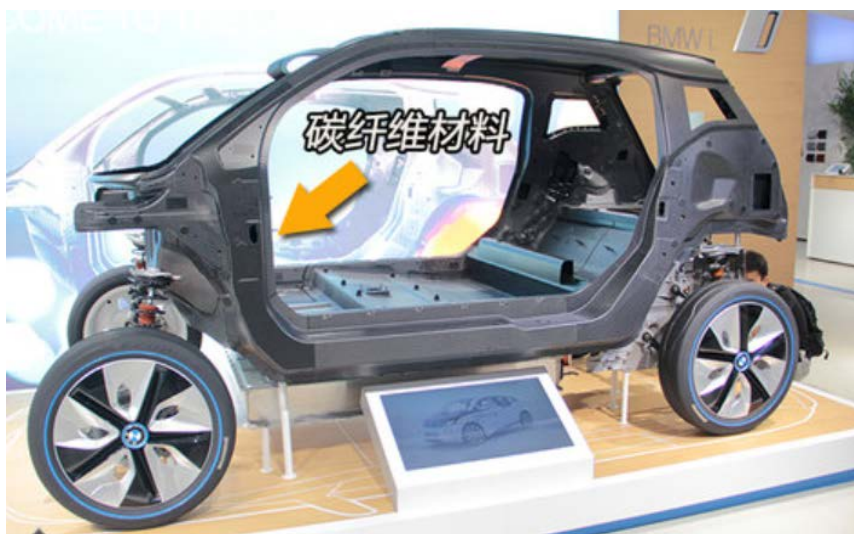
图: 宝马 i3 碳纤维复合材料车体结构图
