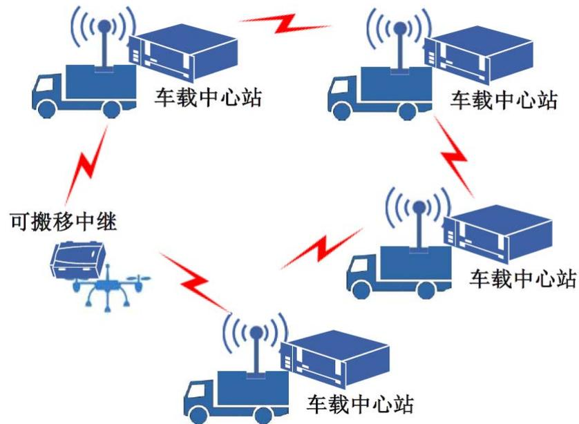
车载中心站之间，可构成无中心无线自组网，形成星型、线性和网状的拓扑结构，可以实现在指挥所内部构建宽带移动局域网。
