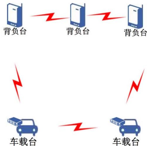
各型终端如背负台、车载台之间，可构成无中心无线自组网，实现终端脱网直通。
