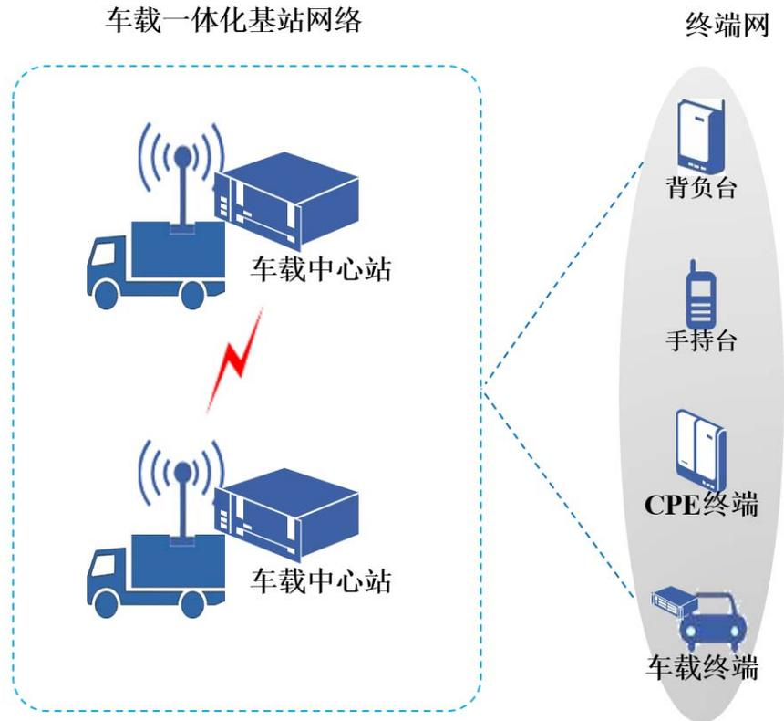
车载中心站是安装于专用通信车的移动中心基站，适用于高机动使用环境，具有较大的发射功率，一体机设计，集成了交换机和业务服务器的功能。当附近有车载中心站时，各型终端也均可随遇接入并获得服务。
