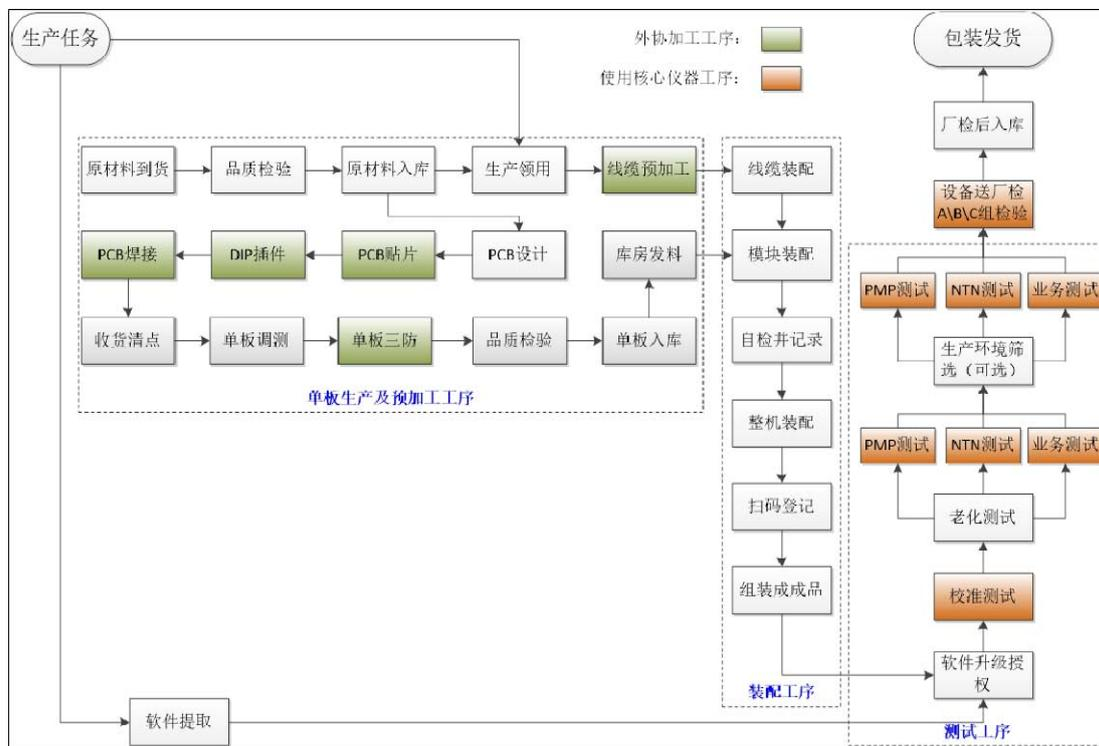
单板生产及预加工工序中，PCB 板的加工工序及部分线缆预加工通过委托外协的方式完成，如上图绿框所示。其余 PCB 设计、品质检验、单板调测等环节，由公司自有人员完成。其中单板调测自动化程度高，采用配套工装夹具和自研自动化测试工具进行一键测试。由于单板调测与部分测试工序（整机软件升级授权、老化测试、生产筛选测试）均采用自研测试平台，自动化测试程度高，由整机测试人员兼顾单板调测工作。
