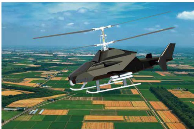
赛鹰SY450H最大起飞重量450千克，升限满载状态达到4000米，减载状态达到海拔5000米以上，续航能力超过3小时，悬停能力为每小时100千米；Rotax914航空发动机带有涡轮增压器，降低了因高海拔飞行损失过大问题。
