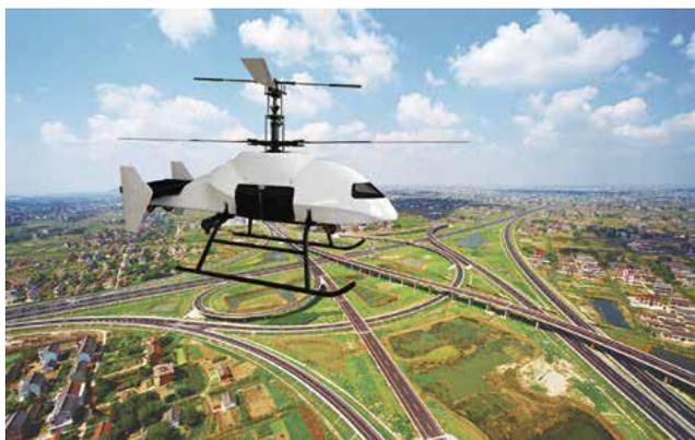
赛鹰SY261H是为农业和工业用途设计的共轴双桨无人直升机，采用共轴双旋翼布局可即保持较高的重量，气动效率，同时又具有体积小结构紧凑的特点。拥有先进的控制系统和良好的环境适应性，配合不同的载荷可广泛应用于农业植保，航拍测绘，线路巡检，抗灾救援，及商业运输等。
