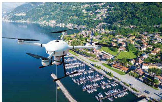
赛鹰SY4000T基于系留悬停技术，由地面电源模块通过光电复合缆向悬空平台供电，使其获得不间断的续航能力，并提供双向传输信号，数据传输速度可达每秒百兆。
