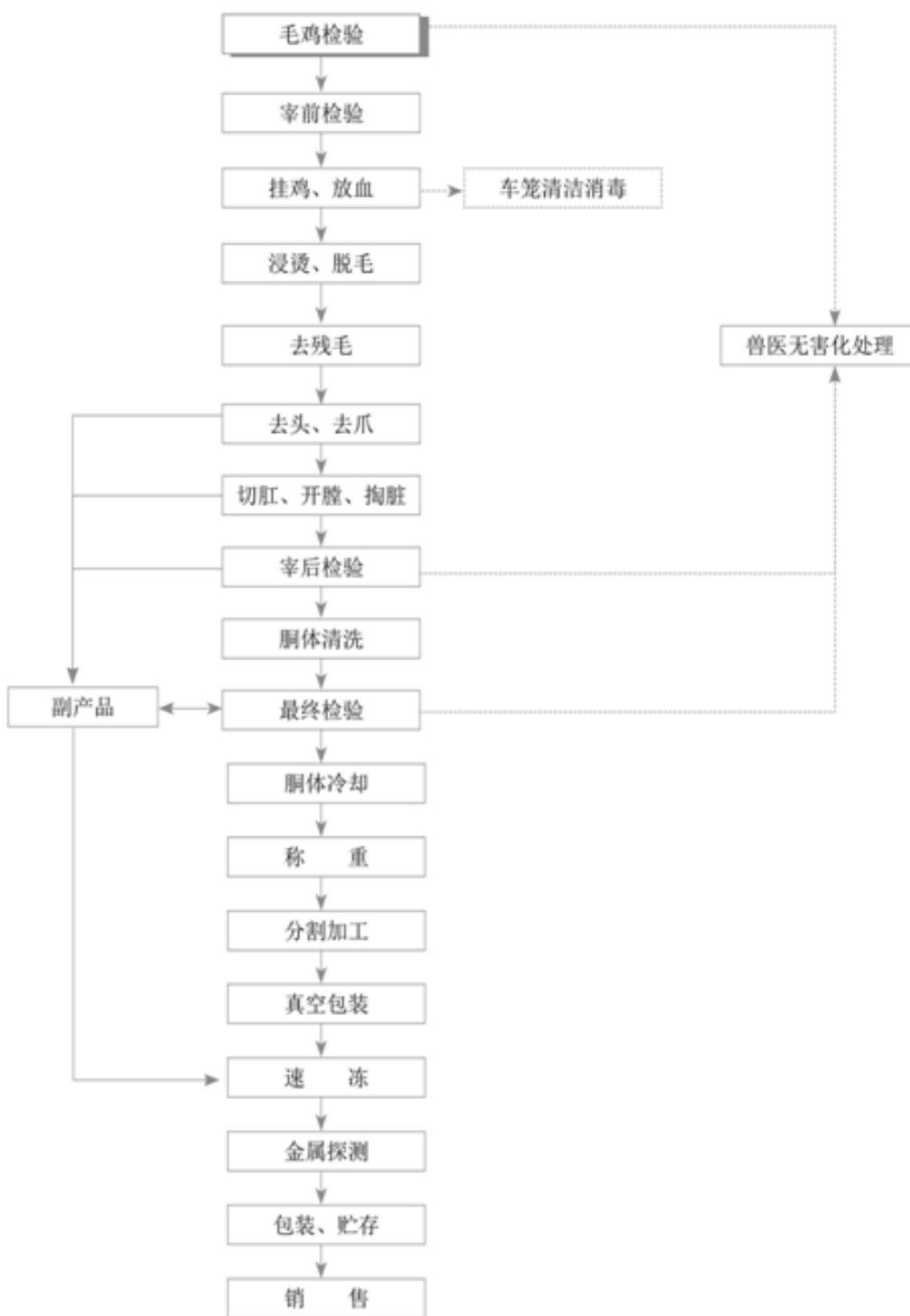
肉鸡屠宰及加工业务由子公司民和食品经营，拥有世界领先的荷兰斯托克（STORK）公司生产的肉鸡屠宰加工生产线，宰杀掏脏采用全自动的方式，设备配有高压清洗系统，从而避免了员工工作时的交叉感染。加工中通过多道检验程序和宰后同步检验检疫，保证了鸡肉产品的质量。
