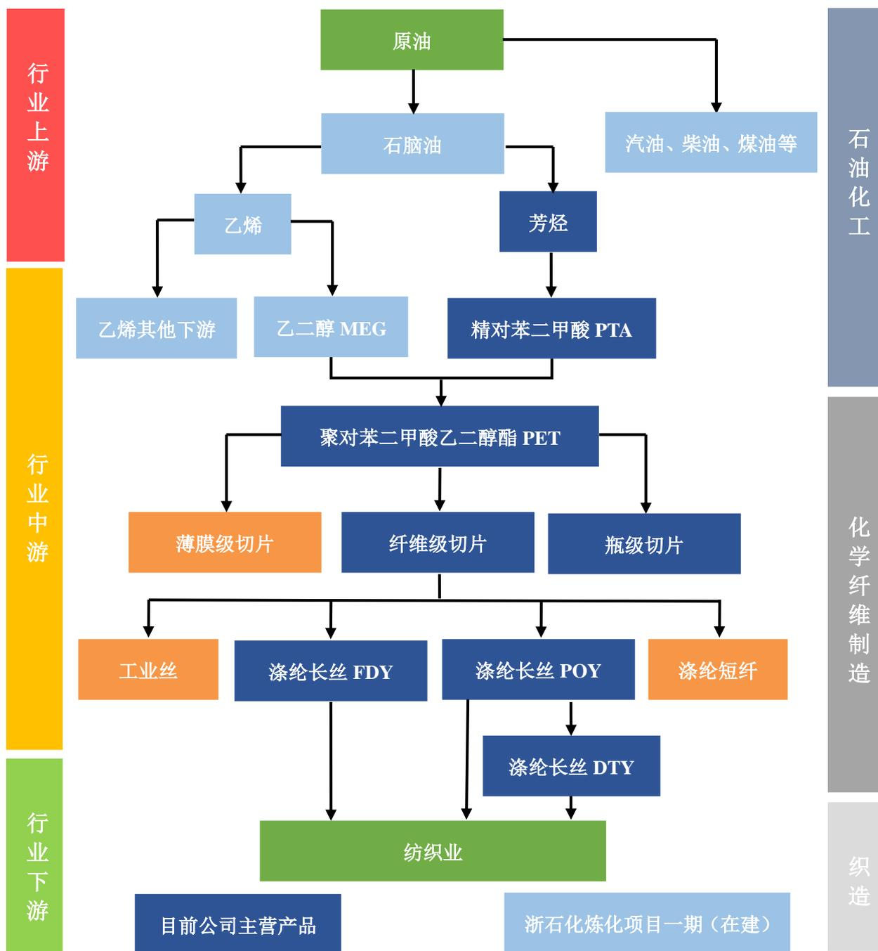
芳烃是芳香烃的简称，通常指分子中含有苯环结构的碳氢化合物。芳烃主要包括苯、甲苯、二甲苯等，是生产石油化工产品最重要的基础原料之一，主要用于制造合成树脂、合成橡胶、合成纤维、表面活性剂等，也可以用作溶剂或添加剂。
