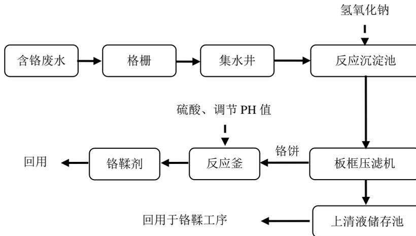
对复鞣染色阶段需要处理的含铬废水，由于其中杂质较多，因此，公司设专门管道引入处理设施进行处理：含铬废水经格栅去除大颗粒的悬浮物后进入集水井，再通过泵抽入反应沉淀池，分别加入石灰和絮凝剂并采用机械搅拌器搅拌使其充分进行中和、混凝反应，再通过泵将充分反应后的含铬废水全部抽入板框压滤机进行压滤脱水，将含铬废水中的铬金属与污泥一同过滤截留，产生的滤液进入综合废水处理系统的调节池进一步处理。板框压滤机压滤脱水处理后的含铬污泥送往有资质单位进行处置。
