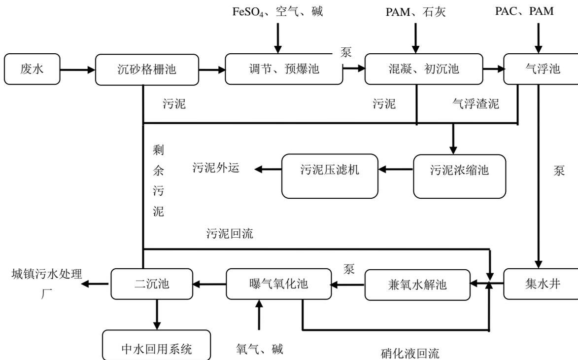
B、中水回用系统工艺流程：
