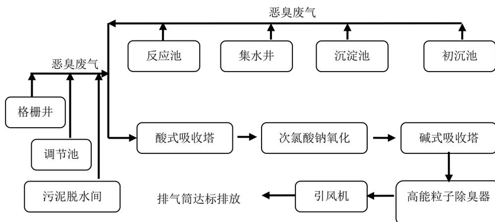
⑤ 毛皮库产生的恶臭气体经过处理后通过 15 米高的排气筒排放，具体处理工艺流程如下：
