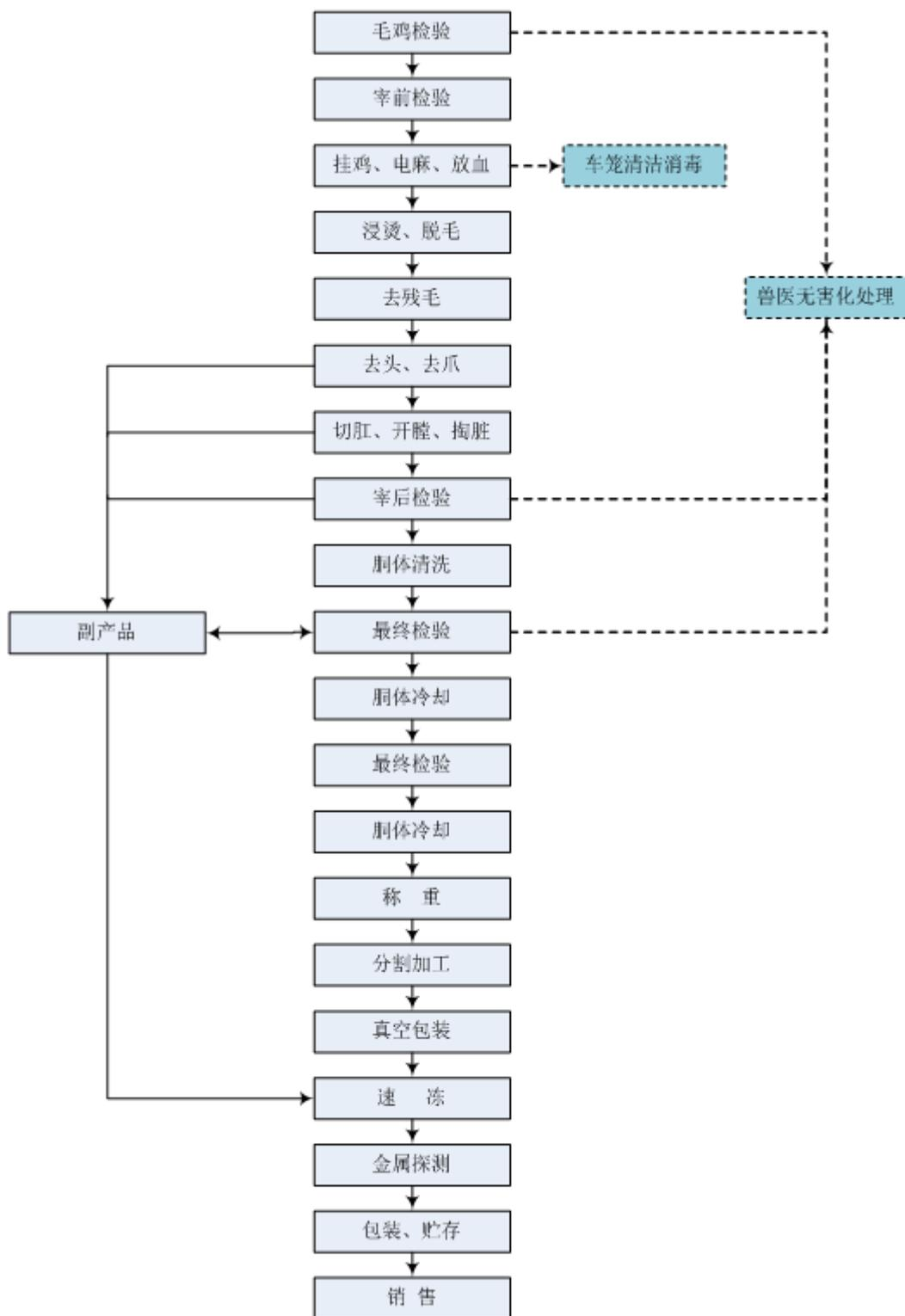
肉鸡屠宰及加工业务由子公司民和食品经营，拥有世界领先的荷兰斯托克（STORK）公司生产的肉鸡屠宰加工生产线，采用西方先进的“无痛苦”电击、自动放血技术，防止了放血时的污染，同时达到最佳放血效果。宰杀掏脏采用全自动的方式，设备配有高压清洗系统，从而避免了员工工作时的交叉感染。加工中通过多道检验程序和宰后同步检验检疫，保证了鸡肉产品的质量。
