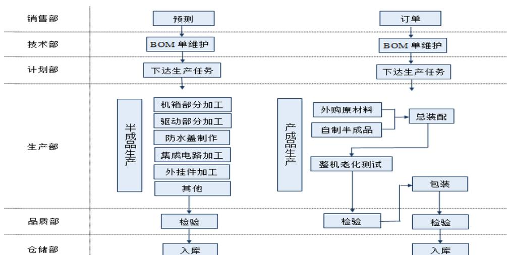
公司产品主要部件的生产和装配均自主完成。同时，公司也根据具体零件生产工艺要求和自身生产条件适当委托外部单位完成部分工序。公司委外加工包括激光开料、电路焊接、表面处理等工序环节。
