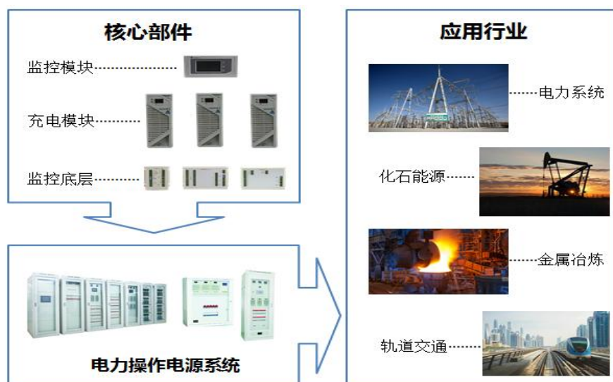
图2 电力操作电源产品核心部件及应用行业
