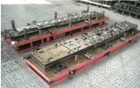
方向盘气囊支架连续模
