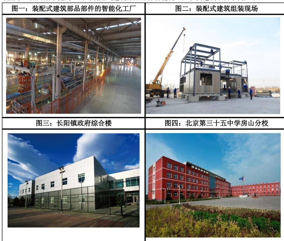
公司以终端客户的需求为导向，从设计环节到模块化加工，“智能工厂”能按细分的模块图纸要求，自动完成水电管线布局和控制面板槽盒预留的定制化生产。公司主要装配式建筑部品部件及其用途的具体情况如下：
