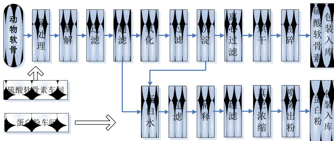
如图所示，硫酸软骨素生产流程的超滤和沉淀环节会分离出浓度较高的蛋白水，这些蛋白水经收集后进入蛋白粉车间进行加工处理，最终产出蛋白粉。
