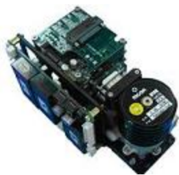
中波制冷红外热像仪 机芯组件
