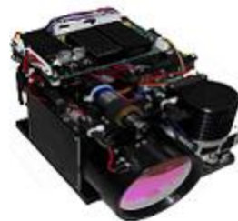
长波制冷红外热像仪
