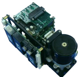
长波制冷红外热像仪 机芯组件
