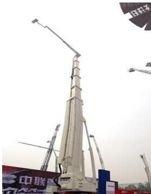
“十二五国家科技支撑计划”——中联重科DG113百米级举高消防车
