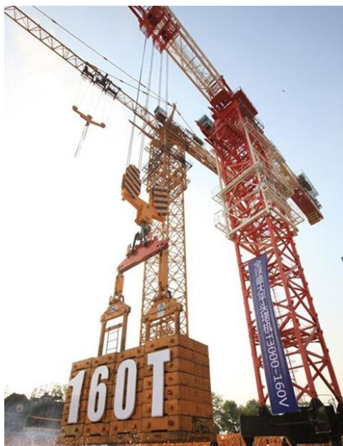
中联重科全球最大T3000-160v平头塔机
