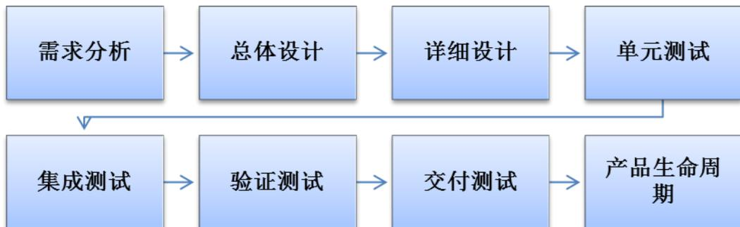
(1) 需求分析：包括客户需求、设计需求及系统需求等，同时收集相关工程需求如可行性、EMC、防护、安全、环境等需求，相关产品形成概念，并进行产品概念评审。
