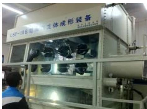
在该领域的领先优势。同时公司在原有同轴激光熔覆技术的基础上研发出同轴智能随动送丝和送粉熔覆专利技术，并推出智能型复合金属3D打印机，可广泛应用于汽车、家电等领域高端注塑模具的快速制造，用于航空、航天超高强度钛合金、铝合金零部件的快速制造，用于军用零部件现场的快速制造和修复，以及其他各领域小批量金属零件的快速制造。
