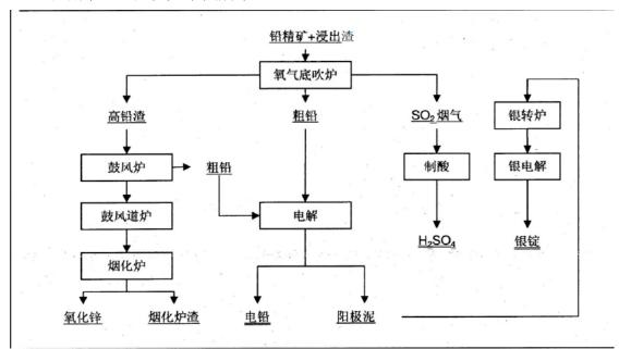
铅冶炼工艺流程如下图所示:
