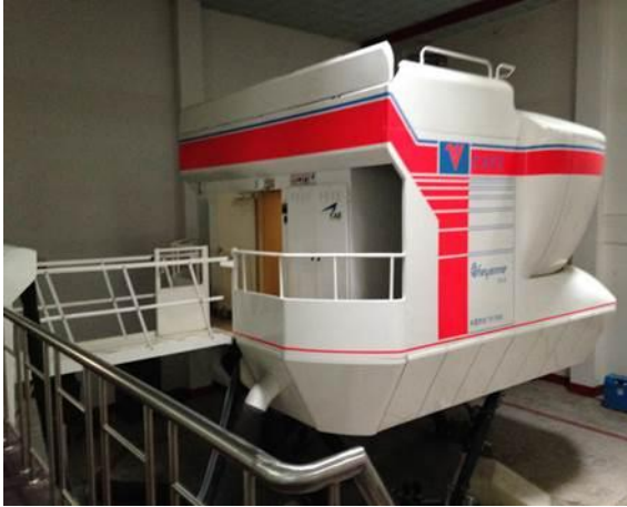
用于视景系统配校的商品飞行模拟机
