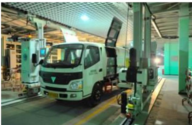
2012年2月,全球最大的电动汽车换电站——北京高安屯全自动换电站正式投入使用,该换电站可同时为8辆电动汽车提供更换电池服务,是全球最大的为乘用车提供全自动换电服务的换电站。公司自主研发的全自动式电池交换机器人系统取得了良好的市场反馈,公司承担的北京数个全自动换电系统成为国内典范。公司将依托新能源汽车行业的发展,应用智能机器人技术为新能源汽车的推广和普及提供高技术水平的配套服务。
