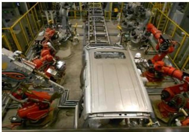
2012年度对于公司新一代工业机器人发展是具有重要意义的一年。公司工业机器人换型成功，并在汽车整车焊装线实现应用，标志自主知识产权的国产标准化机器人成功打破国外汽车生产线的技术垄断。目前公司工业机器人系列产品覆盖6kg—300kg等20多种型号，实现焊接、码垛、搬运、铸造、锻造、智能上下料、打磨、喷涂等多方面应用，满足多行业的高水平自动化的生产需求。
