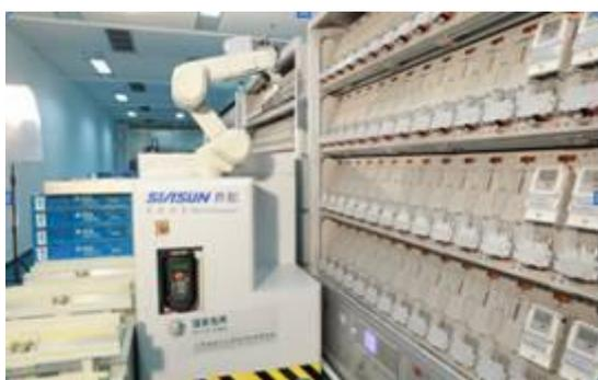
公司自主研发的电能表自动检测系统由智能挂表机械臂、轨道穿梭车（RGV）、无线供电系统等构成，将从自动化立库运输出来的待检电能表料箱进行拆码垛，将待检电能表通过视觉定位在电能表检定台进行挂摘电能表操作，实现电能表的运输、抓取、信息采集和摆放全自动一体化。产品已应用于省级电力公司，有效提升了电能表安装检测的自动化、智能化水平。
