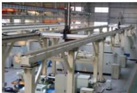
公司智能上下料机器人包括工业机器人、机械手爪、视觉定位系统、过渡平台定位系统、换手台和其它辅助设备。用户可以依靠该机器人系统迅速进行产品结构调整并扩大产能，较大幅度降低人力成本，有效的提高生产效率。本年度公司研发的智能上下料机器人成功应用于客车车轴加工上下料生产线。该产品广泛应用于机床行业，与机床等相关产品结合构成自动化生产单元，实现高产能、高精度的作业要求，极大地提高机械加工的自动化水平。
