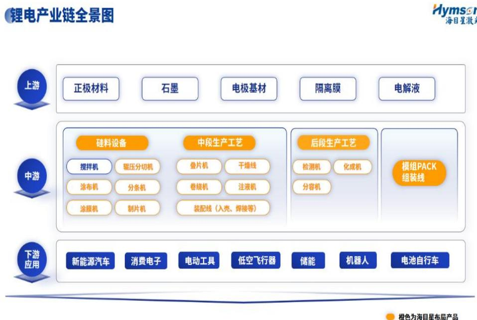
公司提供涵盖方壳电池、圆柱电池、固态电池等各类电池类型在内的锂电池智造整线解决方案。锂电业务核心产品系列涵盖前端设备如涂布机、辊压机、高速激光切割机，中端设备如高速卷绕机
