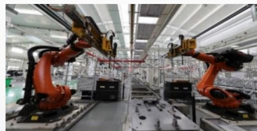
油底壳飞轮壳螺栓拧紧工作站
