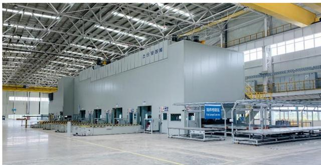
液压机自动化冲压生产线
