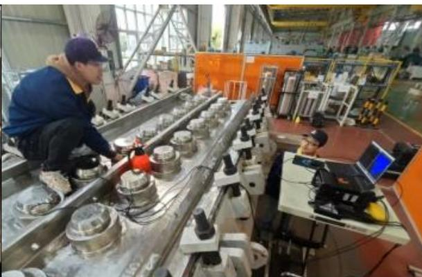
图 2 相控阵超声检测
