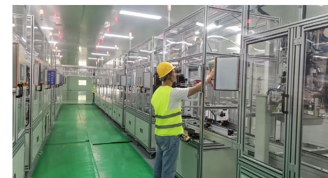
操作人员调试电子水泵生产线
