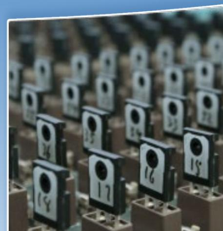
公司第二代、第三代650V和1200V平台的SiC MOSFET多个产品已完成量产考核，进入批量供货阶段，具有低导通电阻以及覆盖车规级高可靠性要求等特点。650V/750V/1200V的第四代SiC MOSFET研发成功，性能处于国内领先水平，目前已进入送样验证阶段。
