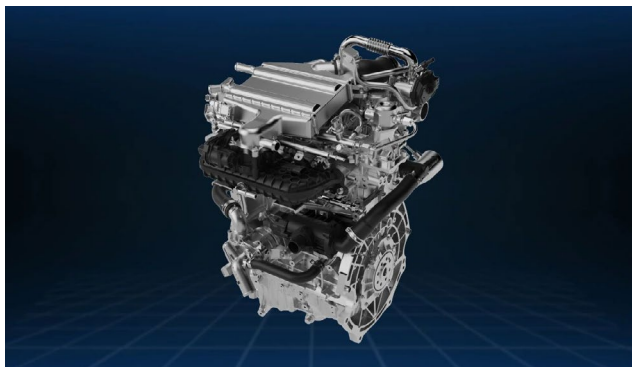
多缸发动机热效率突破 46%
