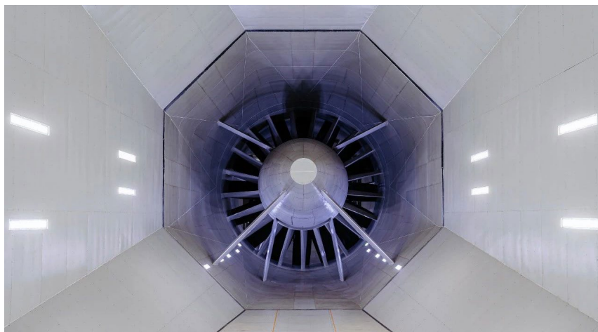
广汽风洞实验室主风机系统
