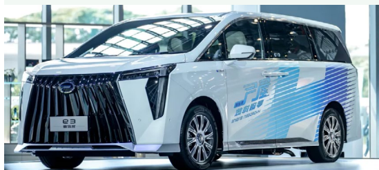
国内首款搭载氢混动系统的整车：E9 氢混版
