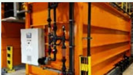
磷化线废水零排装置
