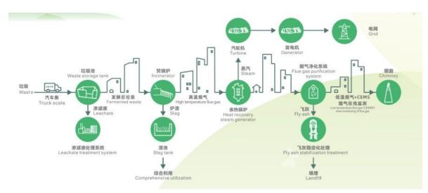
垃圾焚烧发电系统的核心设备是焚烧炉,公司主要使用自主研发的三驱动逆推式炉排炉,该种焚烧炉具有独特的一体式三段设计,干燥、燃烧、燃烬段均配置独立驱动机构,可灵活根据燃烧工况调整各段的运行速度,以更好地控制火床分布,使得灰渣热灼减率更低。
