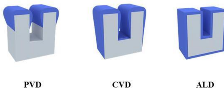
PVD、CVD、ALD 薄膜沉积效果示意图
