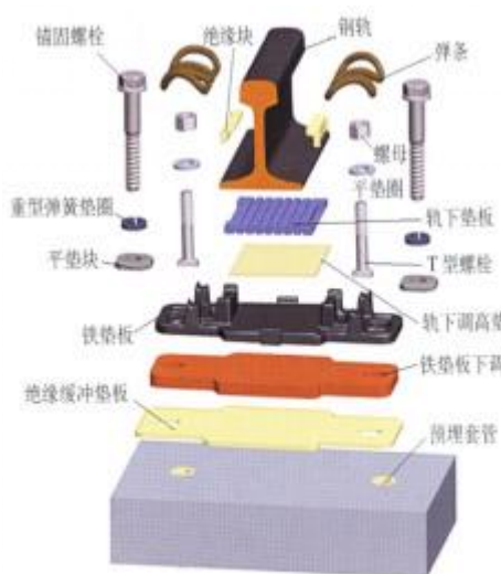
WJ-7型扣件组装零件图
