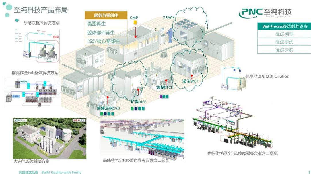
如图，可以看到高纯特气、大宗气系统均和薄膜沉积、干法刻蚀、扩散等工艺机台的腔体连成一个工作面，实现干法工艺目标；高纯化学品、化学品调配系统均和湿法工艺机台的腔体连成一个工作面，实现湿法工艺目标；前驱体系统、EPI 和 ALD 等工艺机台的腔体连成一个工作面，实现其工艺目标；研磨液系统和 CMP 机台连成一个工作面，实现研磨工艺目标。而在制程设备方面，公司重点布局了湿法设备，并在产品平台和工艺搭载上基本覆盖了全部湿法工艺。利用公司对于湿法设备、湿法工艺及配套气化系统的优势，公司布局了晶圆再生和腔体部件再生，以满足核心用户在生产运营周期中的需求。利用公司 20 多年在气体零部件及气路模块的优势，公司布局了支持设备的核心零部件业务，以满足核心终端用户及设备厂商的需求。公司在集成电路领域的布局，立足自身核心技术的优势，为公司长足发展奠定战略基础，力争能够穿越产业不同周期都有平稳营收。
