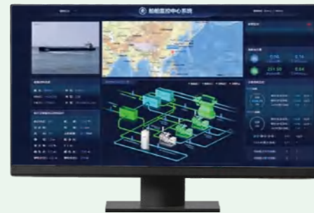
▲ 船舶监控中心系统
