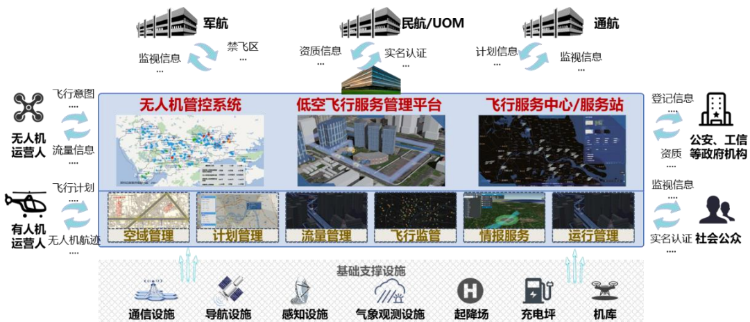
图：低空飞行服务各类系统的运行示意图
