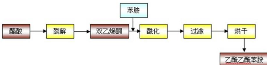
6、乙酰磺胺酸钾的工艺流程
