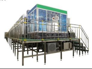
半导体 电镀专 用设备 PLP 镀 铜设备 产品应用场景:应用于半导体、3D 封装等的层间接续用铜柱电镀、回路电镀、玻璃电镀、PLP 半导体电镀等工艺
