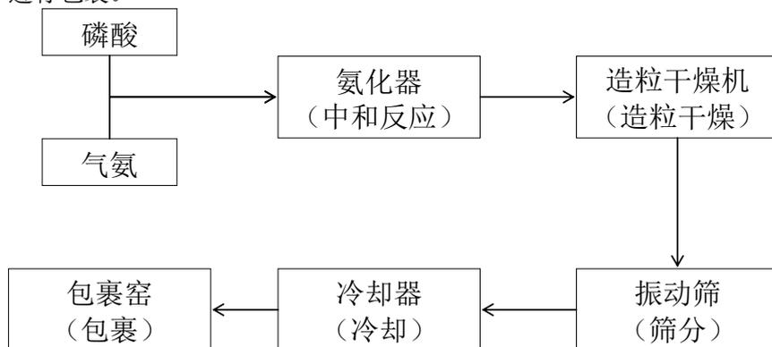
新系统：洗涤液充分洗涤中和、造粒、干燥尾气后，进入管式反应器与液氨反应得到的料浆进入造粒窑造粒，再进入干燥机进行干燥，干燥后的物料在振动筛网上进行筛分，合格粒子经冷却器冷却后送往包裹窑，包上包裹油后进行包装。
