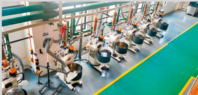
云南贵金属新材料产业园内产品浓缩产线
