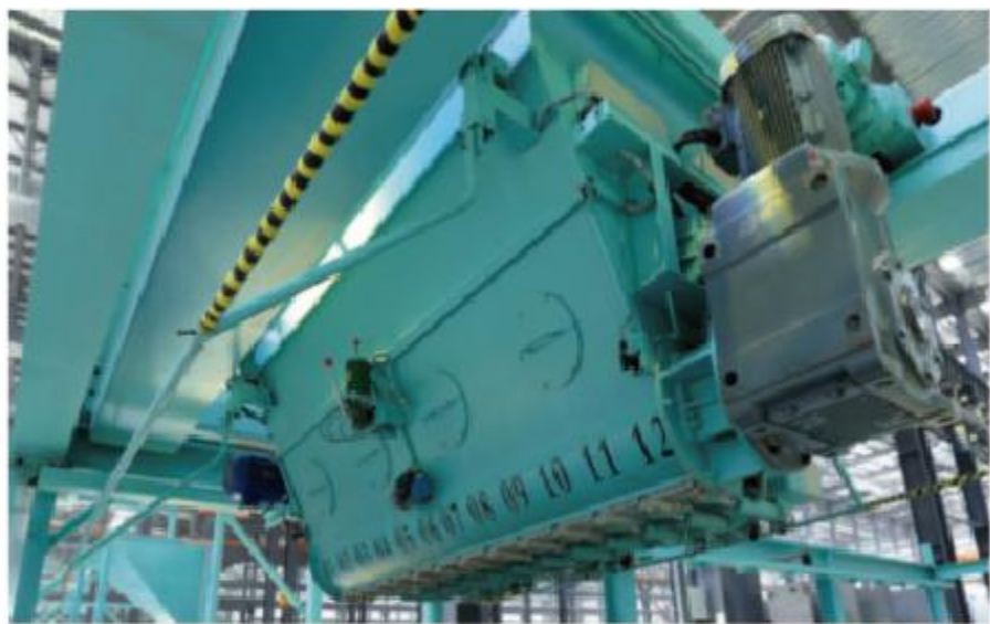
预制混凝土自动生产线
