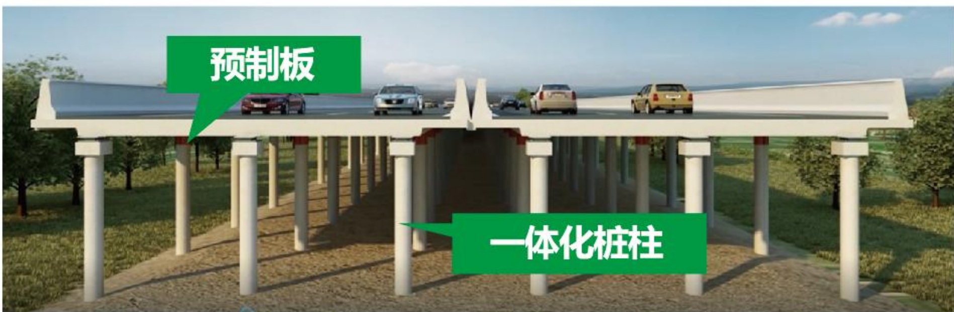
新建桩板结构
