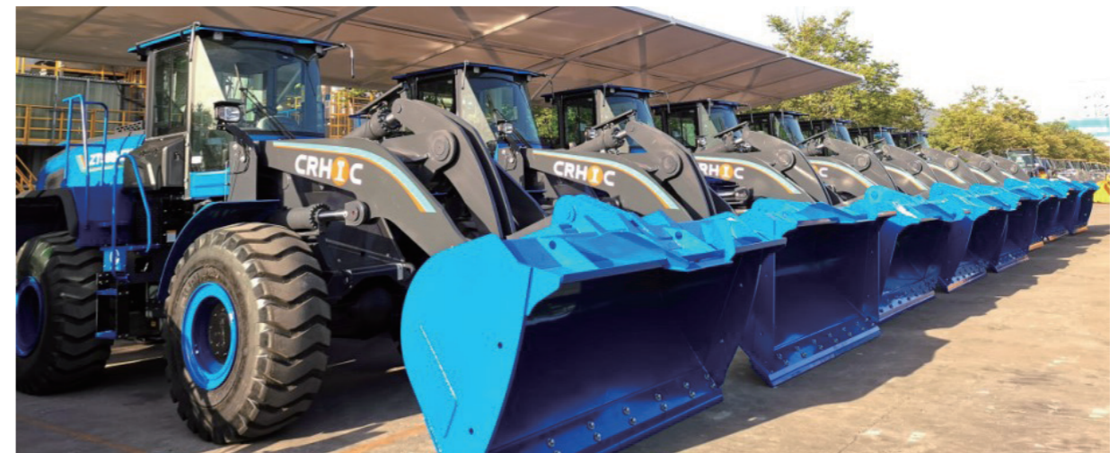
公司所属中铁科工研发的新型纯电装载机成功用于宝武集团新疆天山钢铁厂, 助力钢铁企业实现绿色发展。该 ZT968-EV 装载机采用纯电替代柴油燃料, 装载机运行和液压力机控制均由电力驱动, 可提高能源动力功效 10% 以上, 能耗成本仅为柴油装载机的 1/3。按照每年 5000 小时作业时间计算, 每台 6 吨电动装载机一年可节省 30 余万元, 减少二氧化碳排放超过 150 吨。
