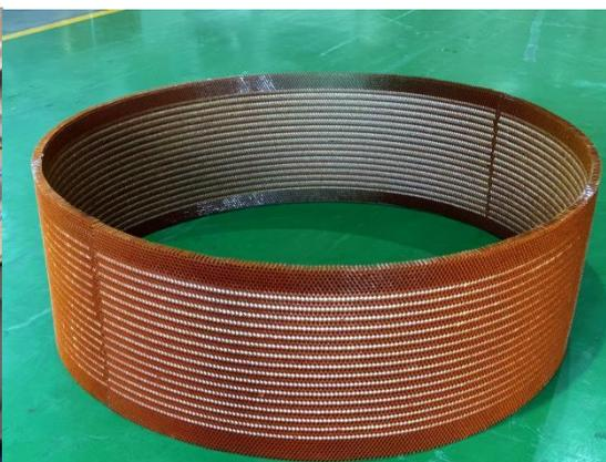
图 5：吸音蜂窝曲面成型技术
