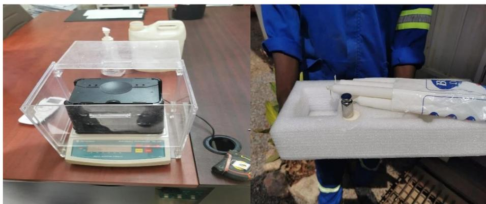
图 3-10 矿石体重测试仪器和蜡封装置
