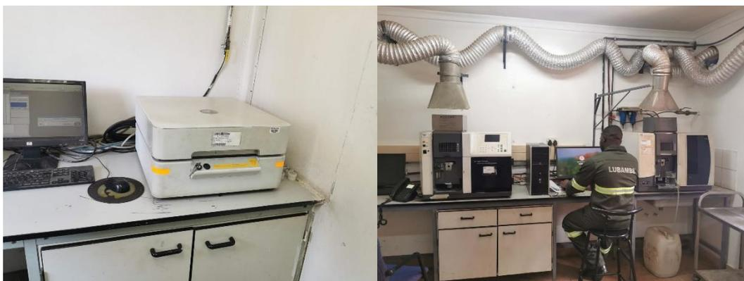
图 3-12 XRF 和 AAS 化验设备
