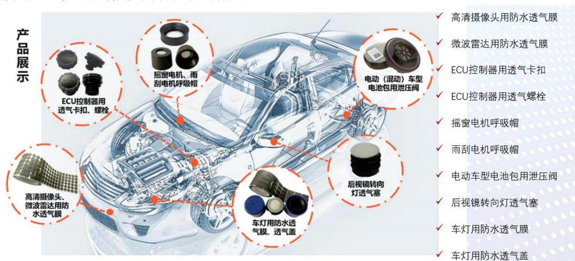
图 2：公司 ePTFE 微透产品在汽车上的应用
