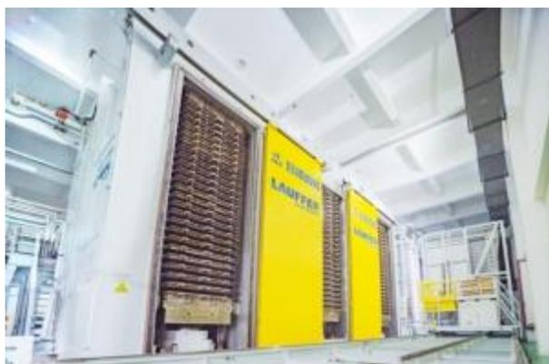
双幅 CCL 真空层压机生产线
