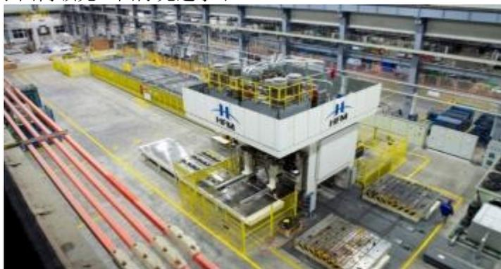
超高强钢直接热冲压成形生产线
