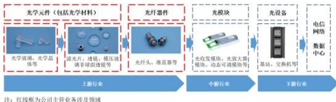
公司的精密光学元组件、光纤器件产品，处于光通信产业链的上游，精密光学元组件是制造光纤器件的基础，光模块又由光学元组件、光纤器件封装而成。例如，光收发模块（光模块的一种，如下图所示）中，其主要构成包括滤光片、偏振分束器（PBS）、消偏振分束器（NPBS）、棱镜、透镜、非球面透镜等各类光学元件，以及环行器、准直器、合波分波组件、光复用器等光纤器件。光电子元件的指标水平和可靠性决定了光模块、光设备的光学性能和可靠性，因此光学元组件、光纤器件构成了光通信产业的基础性支撑。
