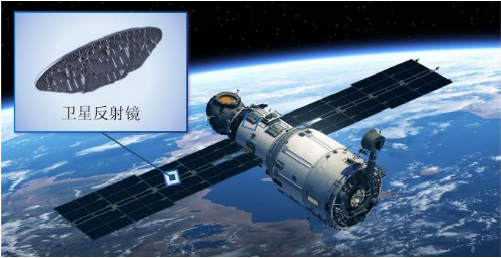
碳化硅反射镜在遥感卫星中的应用示意图
