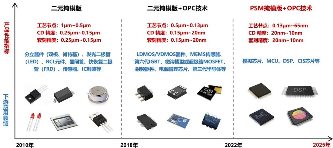
发行人已掌握 130nm 及以上节点半导体掩模版制作的关键技术，形成涵盖 CAM、光刻、检测全流程的核心技术体系。在功率半导体掩模版领域，发行人工艺节点已覆盖全球功率半导体主流制程的需求。
