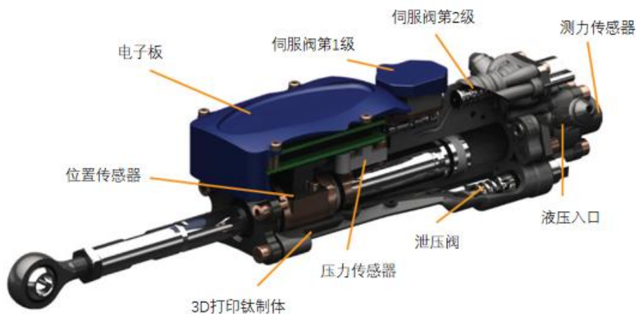
电液驱动关节结构示意图
