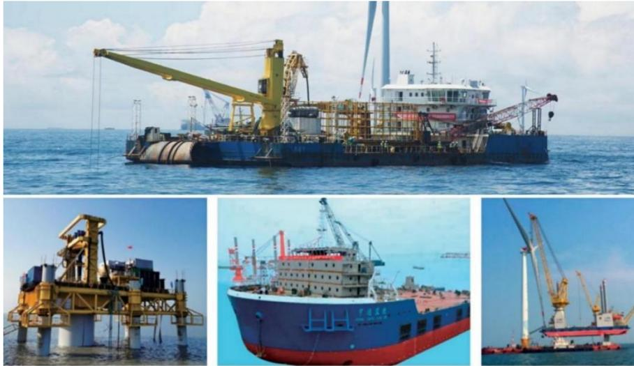
图 13 部分海上施工船（敷缆、嵌岩、吊装等）
