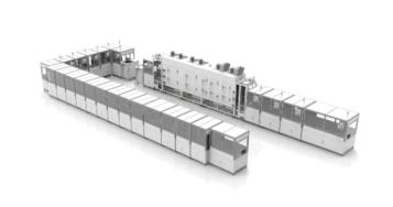
新能源汽车 PTC 热管理器 自动化生产线 整线包含水加热器的焊接、AOI、锁付、视觉检测、点胶、精密装配、伺服压装、控制单元气密测试、自动清洁、EOL 功能测试等工艺。
